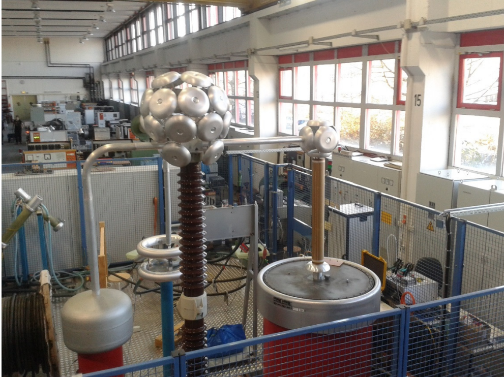
Wechselspannungs-Prüfsystem zur Erzeugung von Wechselspannungen bis 200 kV
