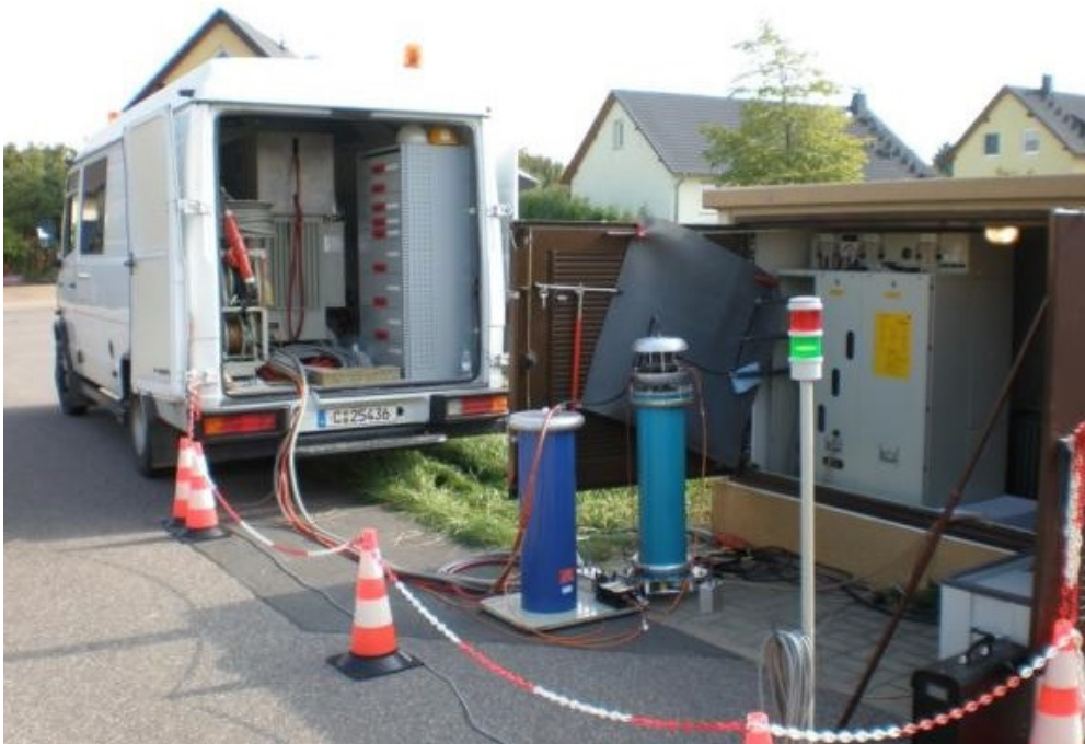
Mobiles Resonanzprüfsystem zur Teilentladungs- und Verlustfaktormessung und Spannungsprüfung
